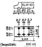
Redlast 133,3 kN Aufstandsfillobe:  $0.20 \times 0.60 \text{ (m}^2\text{)}$ Ersatzfillobenlast:  $p' = 44.4 \text{ kN/m}^2$
