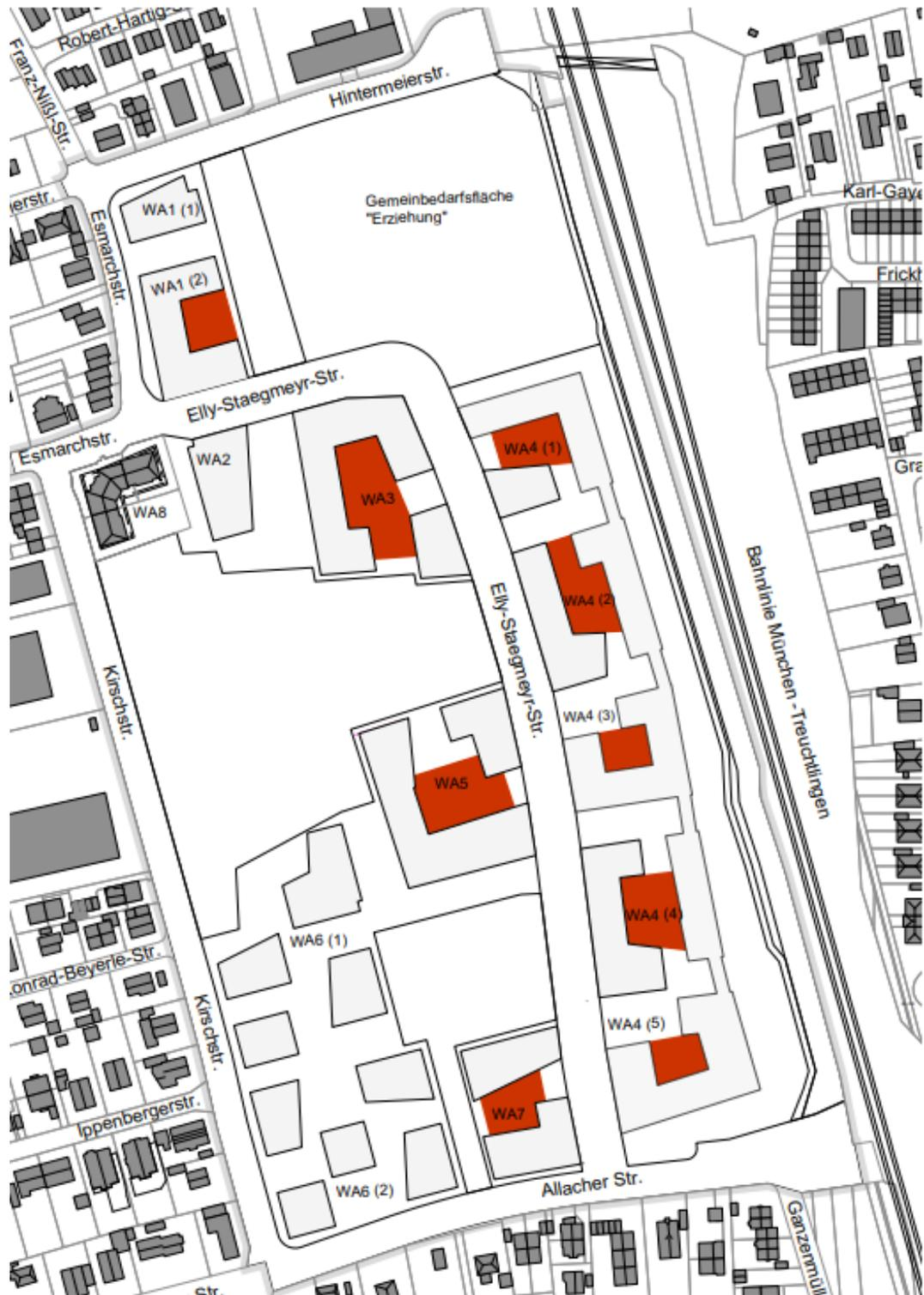
Abb. 3 Grafik: Bereiche ohne Zuluftöffnungen für die Tiefgaragenlüftung – ohne Maßstab, Quelle: © Wüstinger Rickert Architekten und Stadtplaner PartGmbH/LHM
