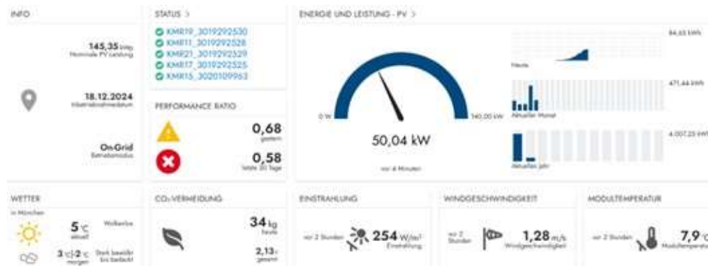
Abbildung 35: Dashboard der Fernüberwachung einer PV-Anlage
