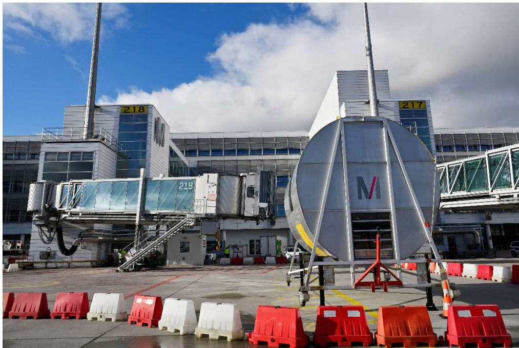
Abbildung 29: Ferngesteuerte Fluggastbrücke im Testbetrieb
