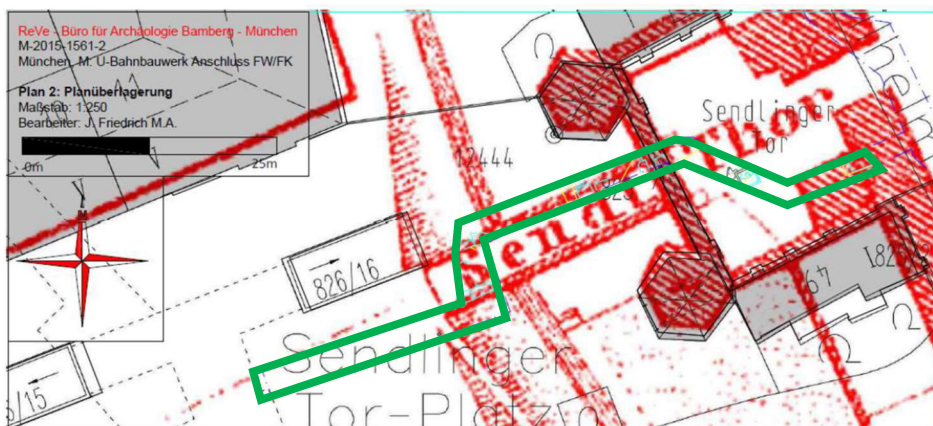
Abb. 16: Die neue Fernkälteleitung (grün) verläuft exakt an der nördlichen Brüstung der alten Torbrücke.
