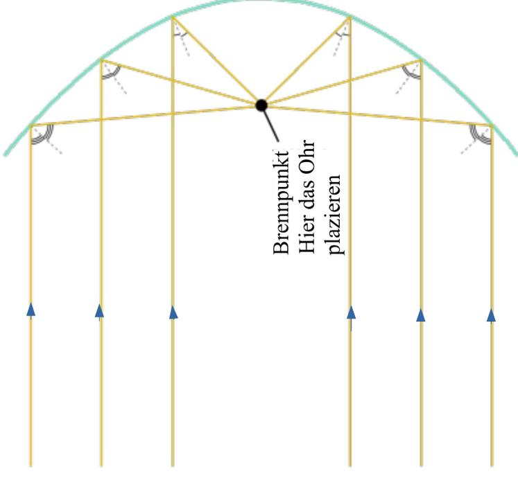
Stellst du dich vor eine der Betonschalen (Parabolschalen) und sprichst /flüsterst etwa vom Brennpunkt aus (Lage s. Skizze) in die Schale hinein, kannst du deutlich vor der anderen Schale gehört werden. Dort muss man sein Ohr auch etwa in die Position des Brennpunkts bringen.
