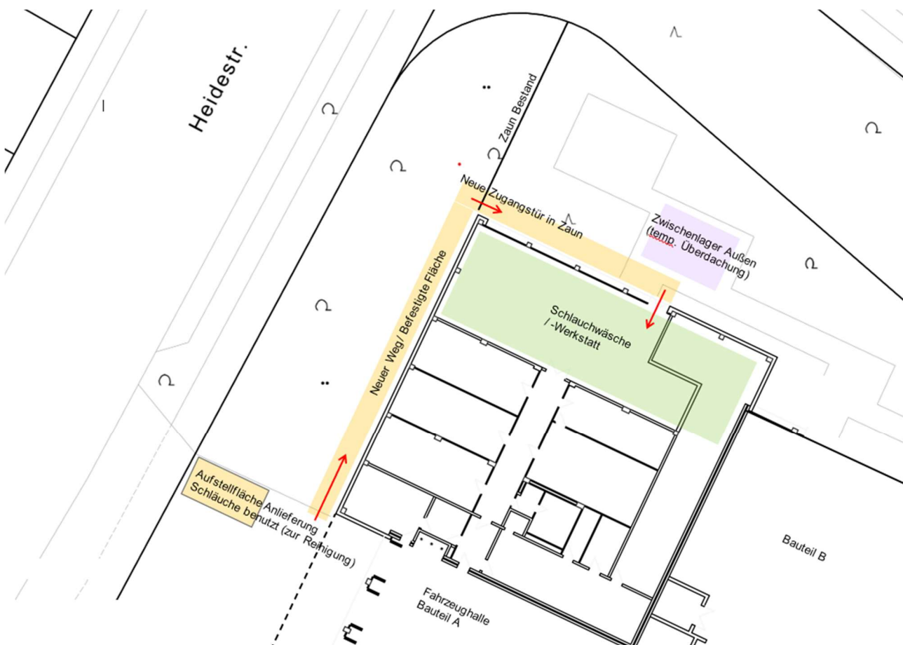
Notwendiger Interims-Weg, Tür in Zaun und temp. Überdachung vor Bauteil A
