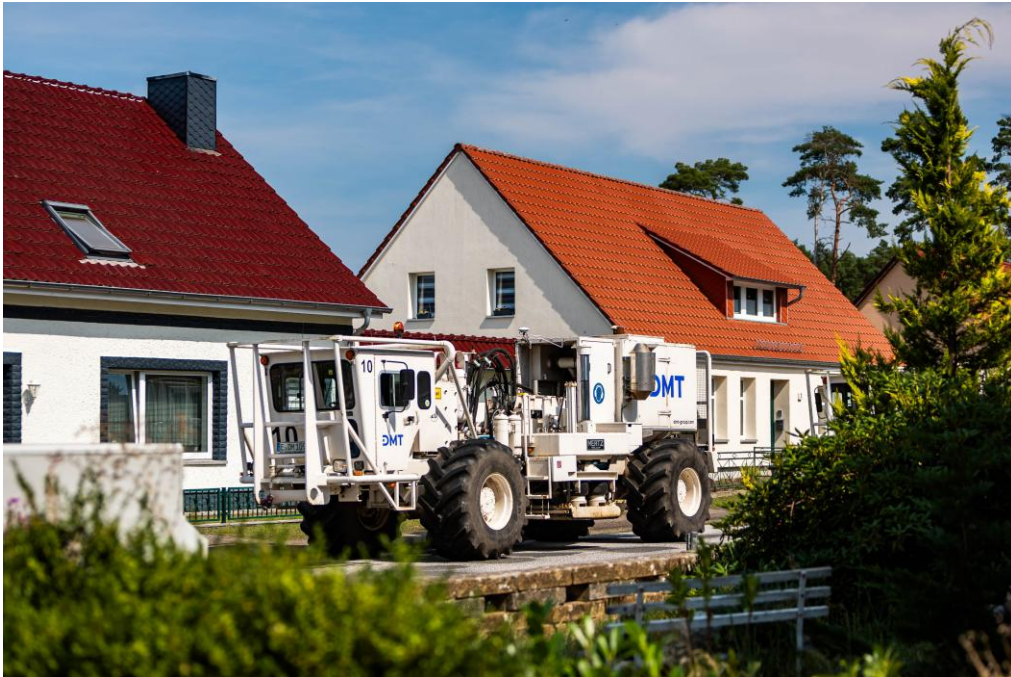
Abbildung 68: Seismische Messung mit Vibro-Truck
